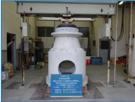
軸方向耐圧試験
